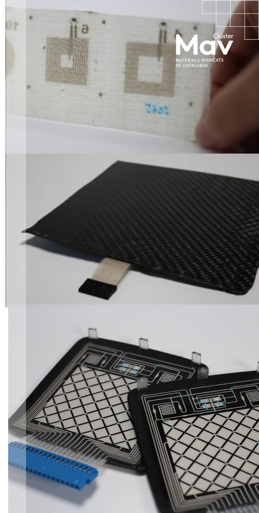
Dispositius electrònics impresos (antenes NFC integrades en materials compòsits)
