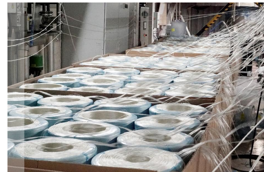
La fibra de vidre s'utilitza com a reforç en el SMC
