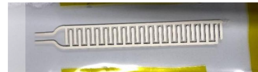
Sensor Flex imprès en silicó
